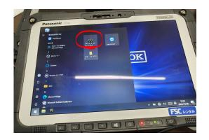
③EXのアプリが開き、左下が接続中になっているか確認してください 再接続となっている場合、操作出来ない状態になります。 (再接続となる原因・・・USBケーブルが外れているか断線の可能性があります。)
