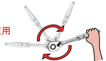
締め込み軸を最初は手で負荷がかかるまで締め付け、重くなったら付属のラチェットで締め込むことでジャッキのシリンダーが伸び荷重がかかります また緩めると荷重が下がります
